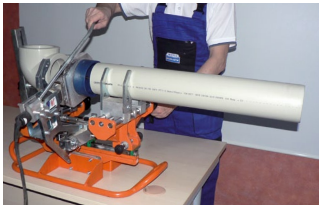
upnutí do přípravku a vycentrování, poté nahřívání
