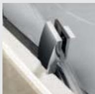
Žádná kolečka, ale jednoduchý a nezničitelný systém otevírání dveří, který nevyžaduje žádnou údržbu. Vlastní pant je tvořen kvalitní nerezovou ocelí zasazenou do těla pantu. Pivot neboli nerezový čep zapadá zcela přesně do plastového pouzdra, ve kterém se otáčí. Díky pevnostním a kluzným vlastnostem materiálů není nutno mechanismus mazat a díky použití pouze dvou přesných komponent je zaručena jeho nezničitelnost.
